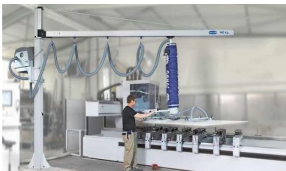
真空バランサーは真空の力を利用してワークの吸着と持ち上げを行なう事ができます。
